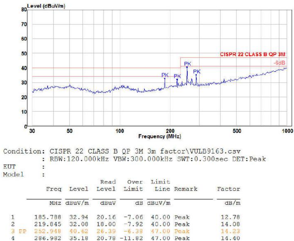
图 5-5 RE 测试水平方向
